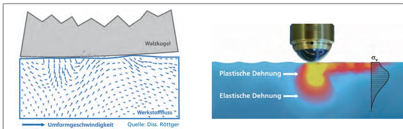
Bild 1: Randschichtumformung
