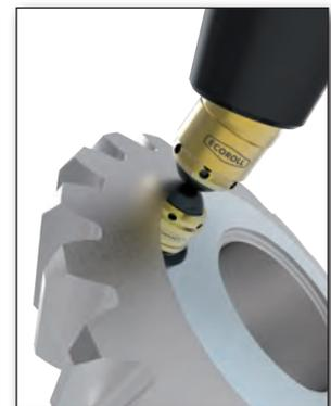
Glattwalzen der Kugelzone eines Kegelrades.
