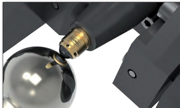
*Glattwalzen eines Kugelgelenkes*
